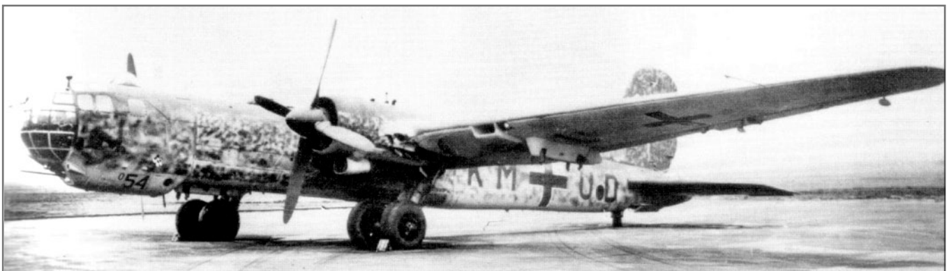
He 177A-5/R6 (KM+UD, Werk Nummer 550054), 6./KG 40, видны пилоны под крыльями для подвески управляемых бомб Hs 293, Франция, 1944 год.
