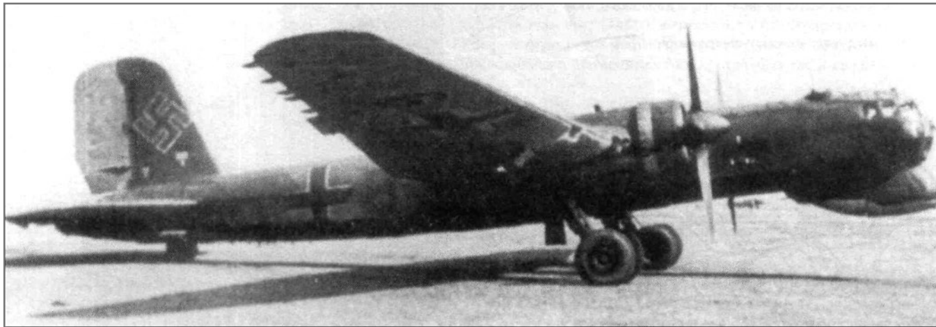
Прототип дальнего тяжелого истребителя ( Fern Zerstörer ) He 177V12 (GI+BL), испытывавшийся в Тарневице. Было также выпущено пять машин в варианте He 177A-1/U2 (иногда встречается также обозначение U1), которые действовали в составе KG 40 - 10./KG 40, затем в 17./KG 40.
